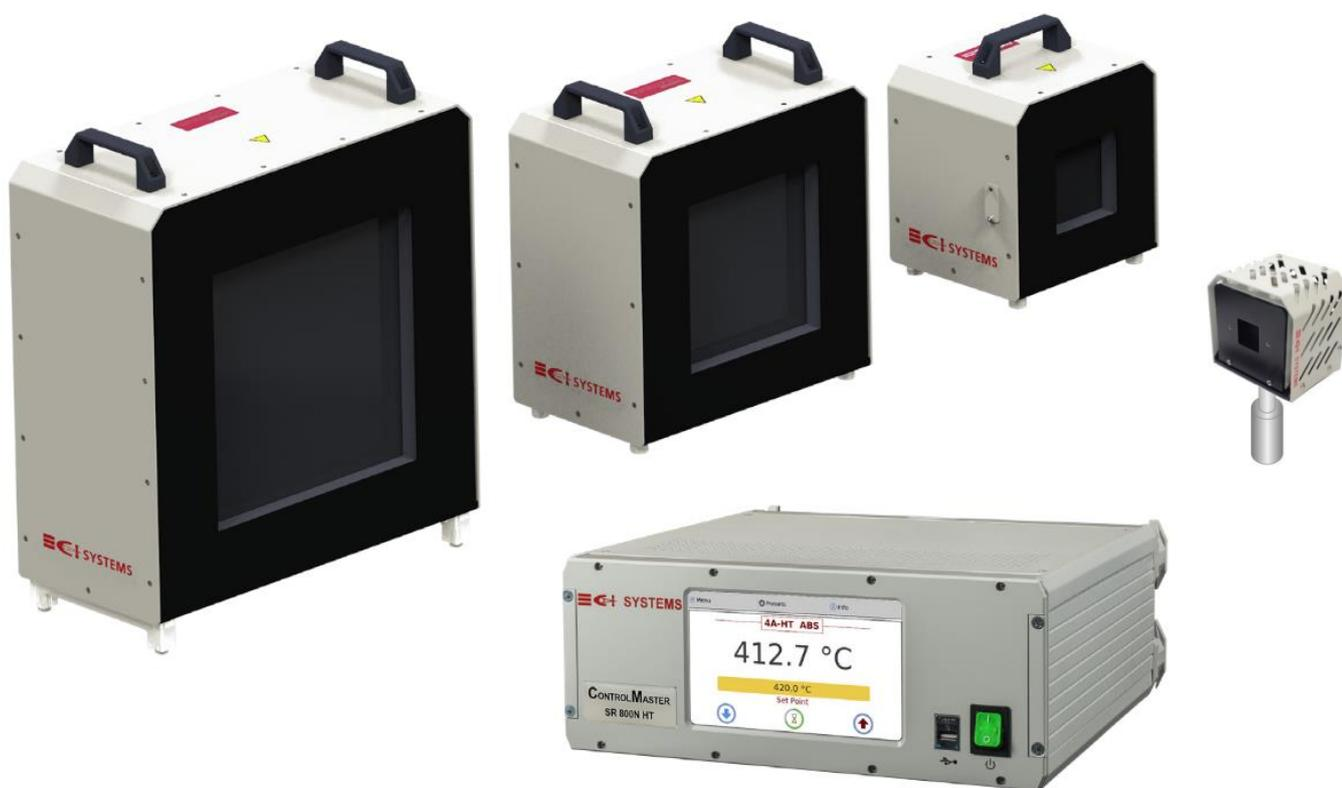
SR800N-HTシリーズは、600°Cまでの高温の平面黒体炉です。35インチ（約90cm）の大口径モデルもありますので、視野角の広いカメラや、距離を離しての測定にもお使いいただけます。高温測定用の赤外線カメラ、サーモグラフィ、屋外での熱目標に最適な黒体炉です。
